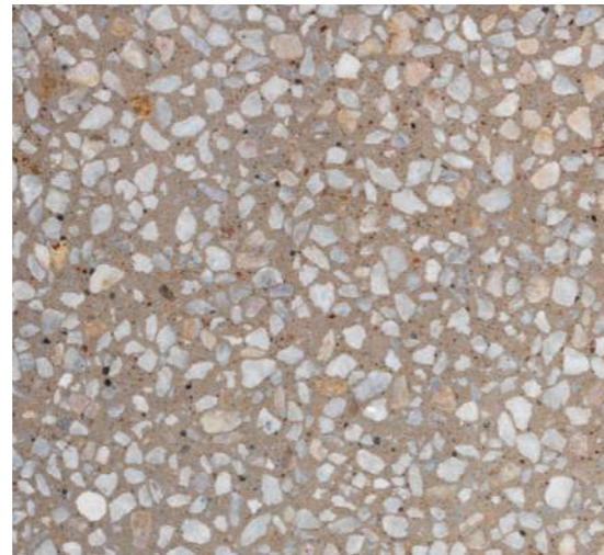
Insitu Concrete (PV2): 'Barossa'
