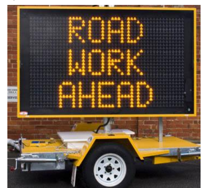
Variable message signage
